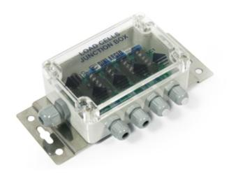
Anschlusskasten, IP67, ausgestattet mit einer Platine für Anschluss und Abgleich von 2, 3 oder 4 Wägezellen. Schraubbare Klemmleisten für einen einfachen Anschluss der Messleitungen und Abgleichwiderstände für einen genauen und zuverlässigen Eckenabgleich.
